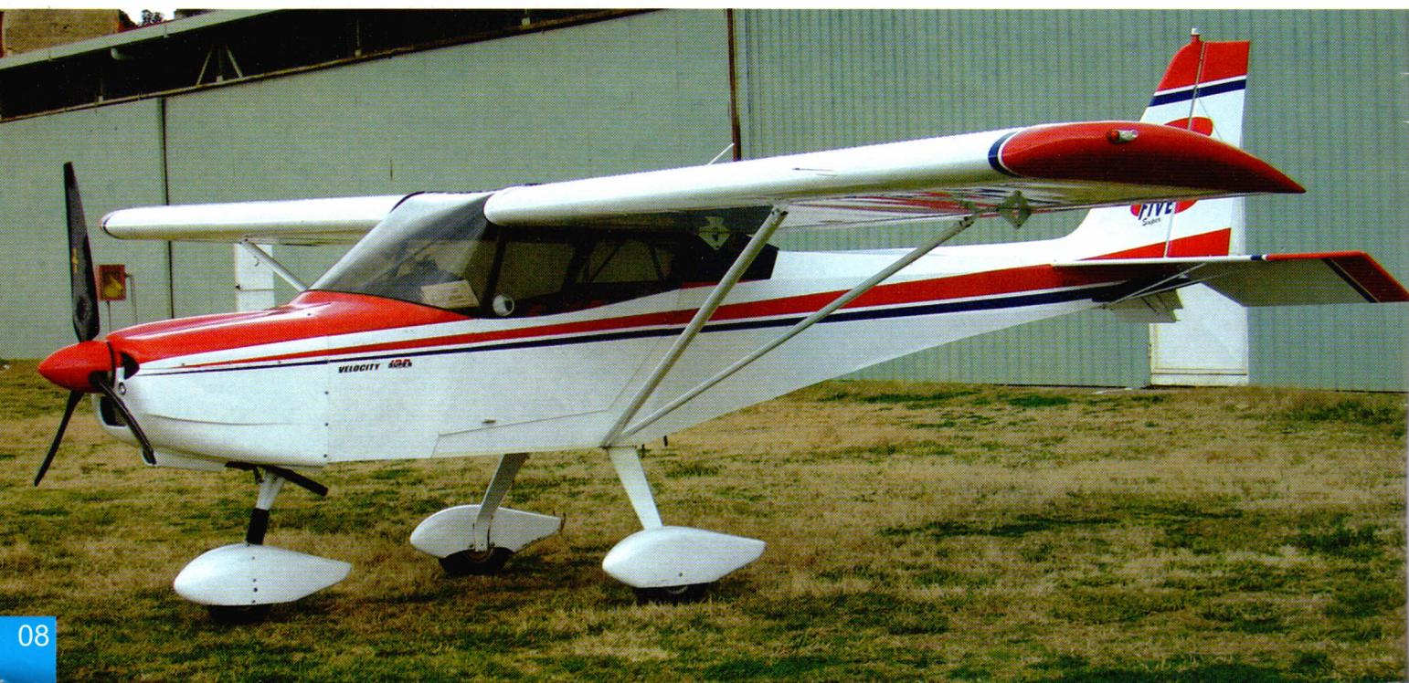
e 5200 giri/min del motore saliamo ad una IAS di 100 km/h ed una variometrica di 800 ft/min continuando ad applicare piede destro. Livelliamo al 60% di potenza (MAP 26 e RPM 4500) ottenendo una velocità indicata di 140 km/h.
